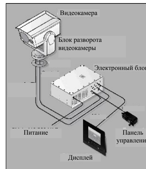
Рис. 3.3. Состав аппаратуры бортовой системы ночного видения фирмы «Spergy-marine».
