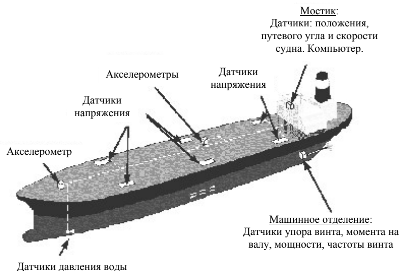
Рис.7.2. Расположение датчиков системы на судне.
