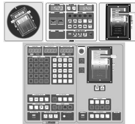
Рис. 6.3. Панель управления главным двигателем, носовым поперечным и кормовым азимутальным подруливающими устройствами
