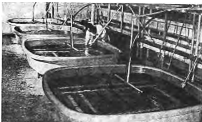
Рис. 23. Модуль инкубационной установки для получения молоди раков
