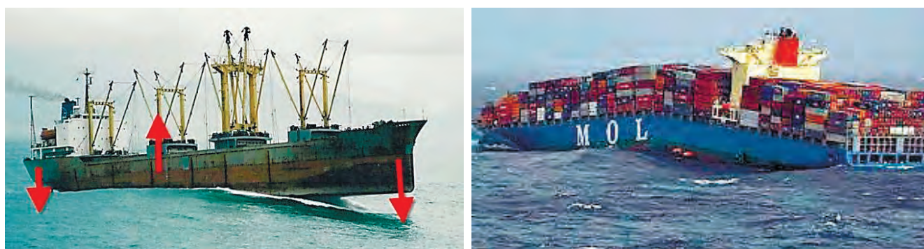
Рис. 1.18. Распределение нагрузок на корпусе судна на волне
