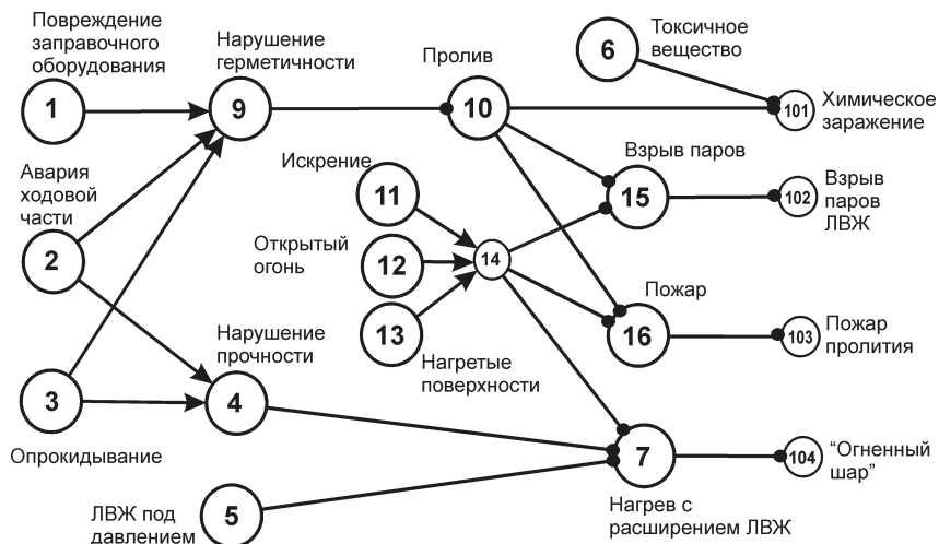
Рис. 2.7.1. Модель формирования опасных факторов при авариях судов, перевозящих опасные грузы
